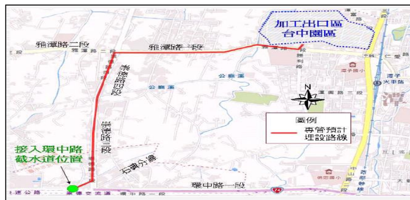
區外污水專管
